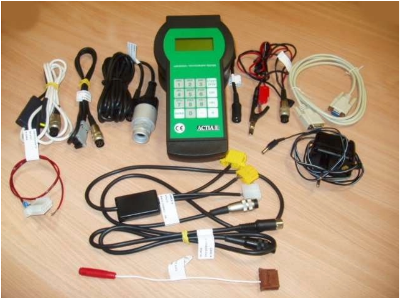
Slika 2. Kontrolni uređaj za ispitivanje tahografa s priborom
